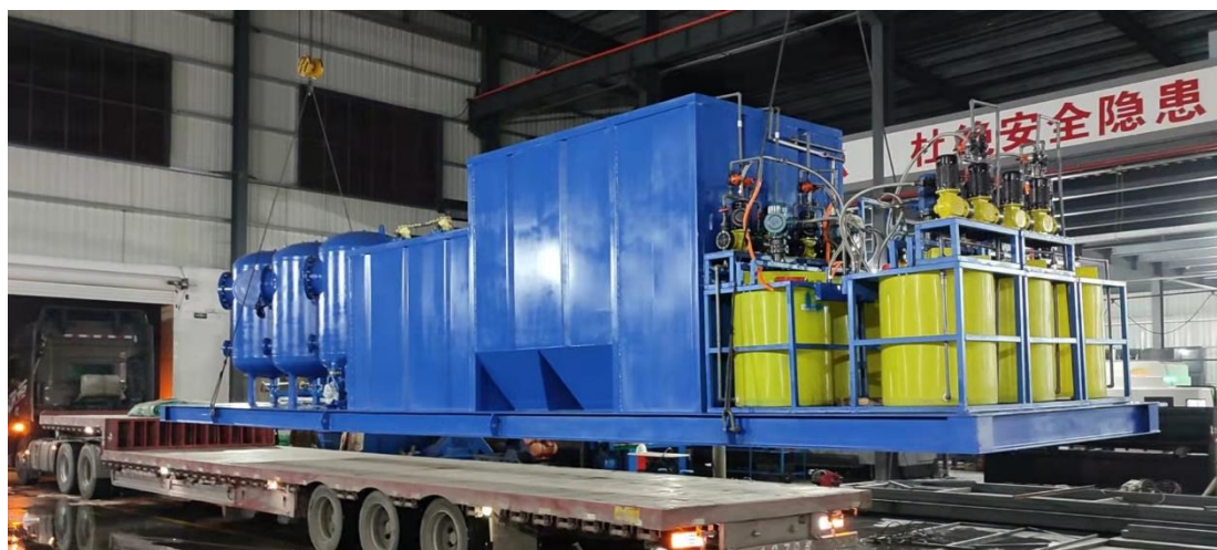
例：（沉淀+气浮+过滤）一体机——10 方中试回配项目
