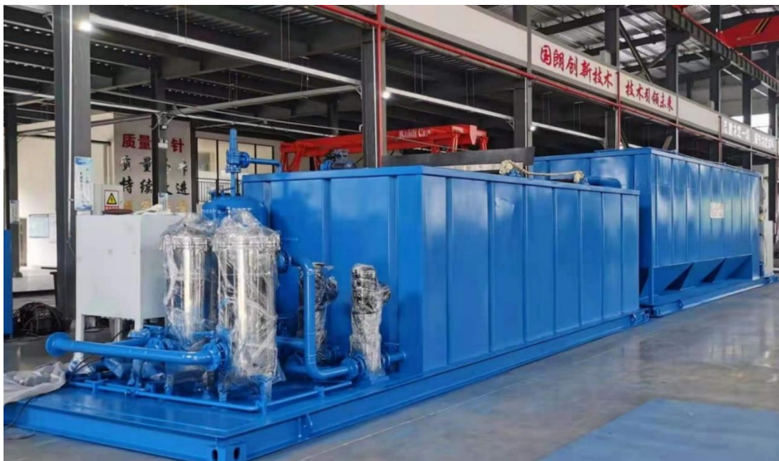
例：高效气浮设备——大庆回注项目
